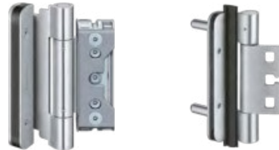
BAKA Protect 4010 3D FD in Topzink oder in Edelstahl, 3D-verstellbar, mit Flügeldichtung, CE-zertifiziert, Belastungswert 160 kg, Rollenlänge 140 mm, Rollendurchmesser 20 mm VARIANT VX 7939 / 160 3D FD MSTs in Edelstahl, 3D-verstellbar, mit Flügeldichtung, CE-zertifiziert, Belastungswert 200 kg, Rollenlänge 160 mm, Rollendurchmesser 22,5 mm
