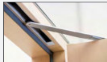
Verdeckt liegender Türschließer im Türblatt / Rahmen integriert, mit elektromechanischer Feststellung. (Ab einer Türblattstärke von 78 mm)
