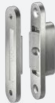
Bandseitensicherung 2 Stück, im Falz eingefräst als zusätzlicher Einbruchschutz gegen Aufhebeln der Tür
