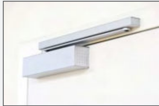
Aufgesetzter Türschließer im Edelstahl-Design, Gleitschiene mit elektromechanischer Feststellung
