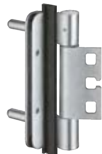
VARIANT VX 7939 / 160 3D FD MSTs in Edelstahl, 3D-verstellbar, mit Flügeldichtung, CE-zertifiziert, Belastungswert 200 kg, Rollenlänge 160 mm, Rollendurchmesser 22,5 mm
