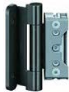
BAKA Protect 4010 3D FD in schwarz, 3D-verstellbar, mit Flügeldichtung, CE-zertifiziert, Belastungswert 160 kg, Rollenlänge 140 mm, Rollendurchmesser 20 mm, auch in Topzink möglich
