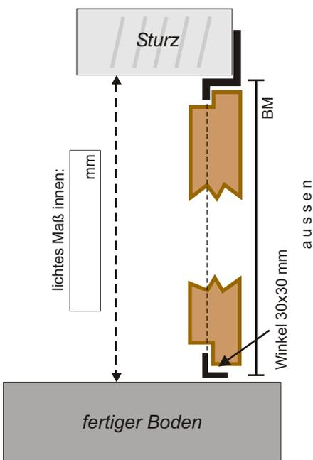
BM = Oberkante fertiger Boden - UK Sturz
