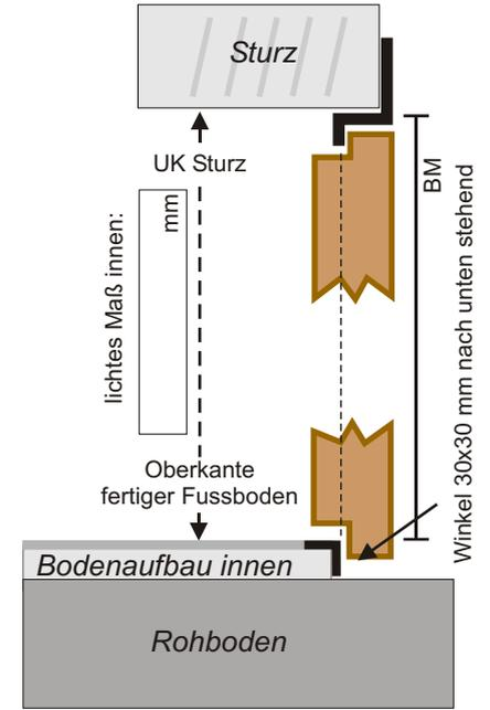
BM = Oberkante fertiger Fussboden - UK Sturz
